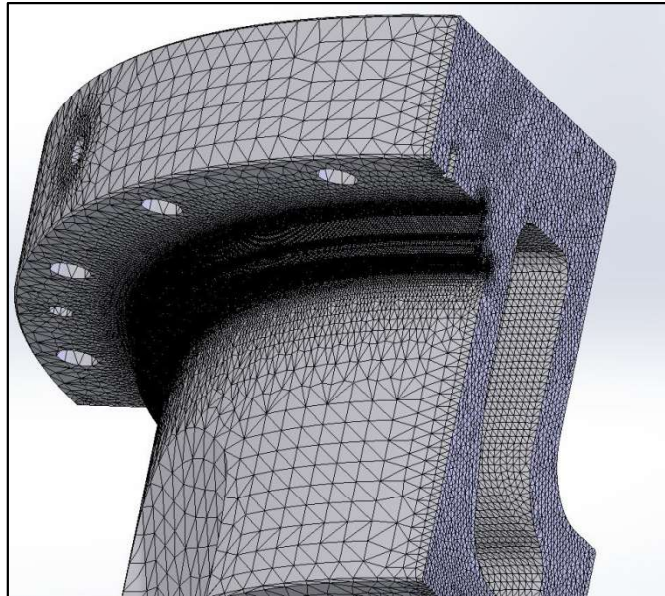
Fig. 16: Particolare affinamento Mesh HPX-740-CP
